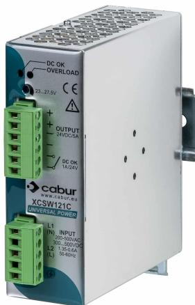
Alimentatore mono-bifase ingresso 230-400-500Vac / uscita 24Vdc 5A
