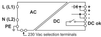
Alimentatore ingresso 1x 230Vac/2x 400-500Vac / uscita 24Vdc 40A
