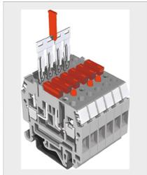
**MPFA.4** - dettaglio dei morsetti con numerazione CNU/8 e CNU/8/51, fusibile "a lama" vista del ponte PTC/4 e vista del ponte PTC. Il morsetto può essere fornito già comprensivo di un circuito di segnalazione LED non polarizzato, per segnalare l'eventuale interruzione del fusibile. Sono disponibili due versioni, in funzione delle diverse tensioni di alimentazione.
