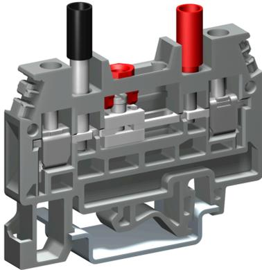
morsetto a vite sezionabile per circuiti di prova e misura, 4 mm<sup>2</sup>, grigio
